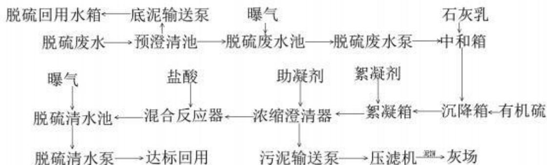
图 3.1-21 脱硫废水处理工艺
