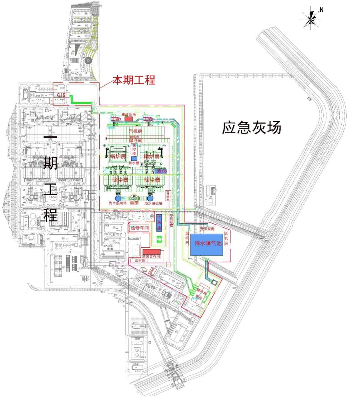
图 3.2-1 本项目厂区总平面图
